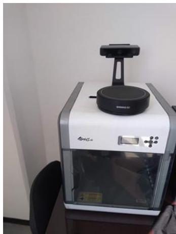
Un escaner 3D de uso industrial, con dimensiones de 570\*210\*210 mm, con volumen máximo, escaneo automático 200\*200\*200 mm y exactitud menor o igual a 0.1mm, resolución de 1.3 megapíxeles y punto de distancia de 0.17mm-0.2mm por un total de \$ 35,492.52 pesos (treinta y cinco mil cuatrosientos noventa y dos pesos 52/100 M.N.), para el laboratorio de prototipado.
